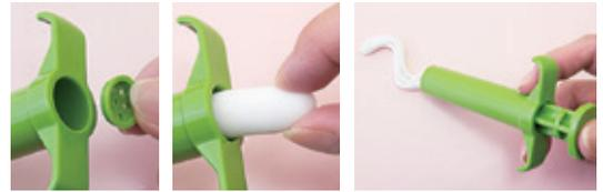
筒の先端にチップを入れ、粘土を入れてピストンで押し出
